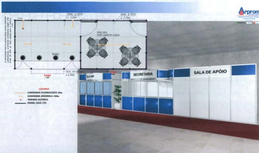
OS-004179 SECRETARIA / SALA DE APOIO (Planta e Perspectiva) 24,0m 2 (5,00m x 4,80m) EVENTO: CONFERÊNCIA MUNICIPAL DA SAÚDE LOCAL: JOQUEI CLUB DE GOIÂNIA DATA: 30/21 E 01 DE SETEMBRO 2007 PROD./PROJ.: ARPROM / FÁBIO ABANTES (25/02/07)
